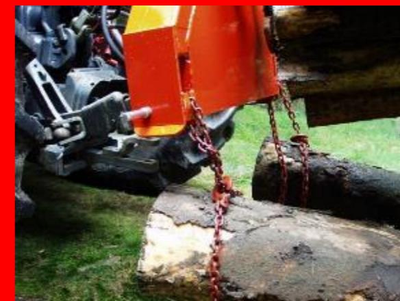
HZ-2300 und HG Modelle haben eine Kettenaufnahme an den Unterlenkern, ermöglicht Stämme durch Seil oder Ketten aus dem Wald zu ziehen.
