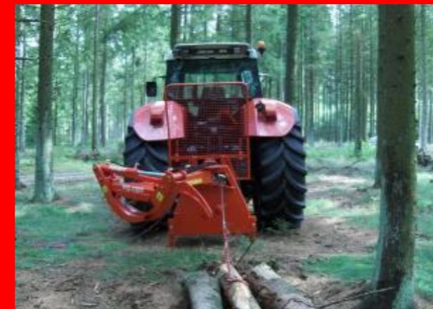
Alle VHZ og VHG Modelle, haben eine 3 Tonnen Winde in der Dreipunktaufhängung eingebaut.
