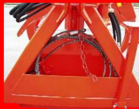
HZ-2300 und alle HG Modelle haben eine Transportkiste, für Seil, Ketten m.m. eingebaut in der Dreipunktaufhängung
