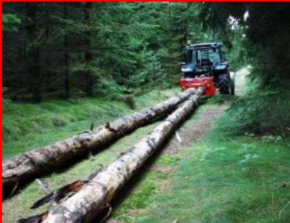
Die Zange zieht leicht Stämme von 20-30 M, Während den Transport soll der hydraulik für den Schwenzkylinder in Schwimmstellung eingestellt werden, wobei die Zange Knäckgesteuert wird.
