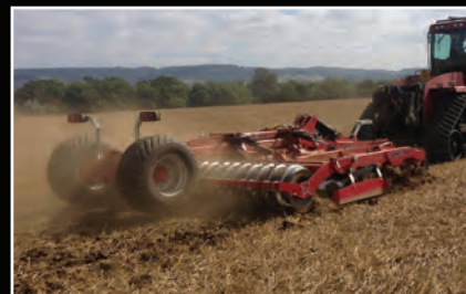
Gründelanfahrschutz mit automatischer Rückstellung
