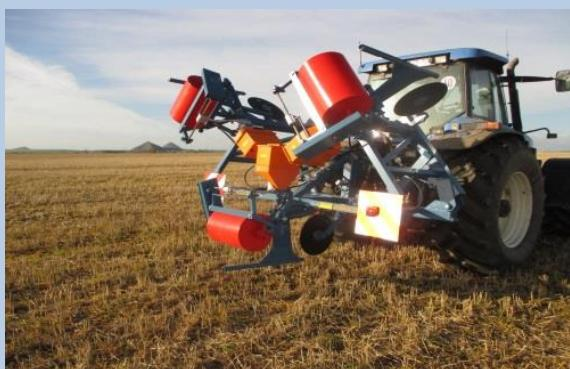
Diese hydraulisch klappbare Maschine hat durch seine 3 gekoppelten Maschineneinheiten eine enorme Schlagkraft. Durch ein einmaliges umfahren der Fläche hat man bereits einen optimalen Schutz vor einwandernden Mäusen geschaffen, aber auch vollflächiges Befahren der Fläche oder von jungen Beständen ist problemlos möglich, um beispielsweise Befallsnester von Mäusen im Bestand dann punktuell zu behandeln.
