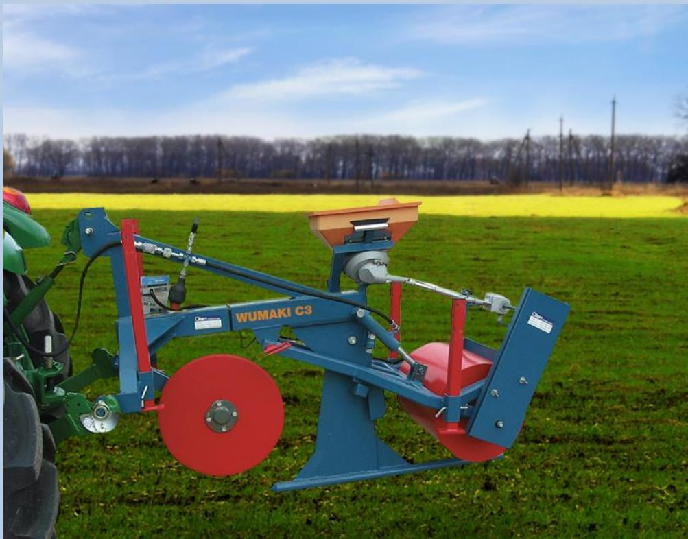
Die Mausköder Legemaschine ist geeignet, um Mäuseköder wie Giftweizen und Giftlinsen unterirdisch und verdeckt auszubringen. Es wird eine hohe Flächenleistung erreicht, dass von Loch zu Loch Laufen entfällt. Mit der Maschine wird in einer Tiefe von 13-20 cm ein künstlicher Mäusegang angelegt, der von den Mäusen sehr gut angenommen wird. In den Gängen werden die Köder automatisch durch die Dosiereinrichtung portioniert und ausgelegt. Die Walze verschließt die Gänge wieder.
