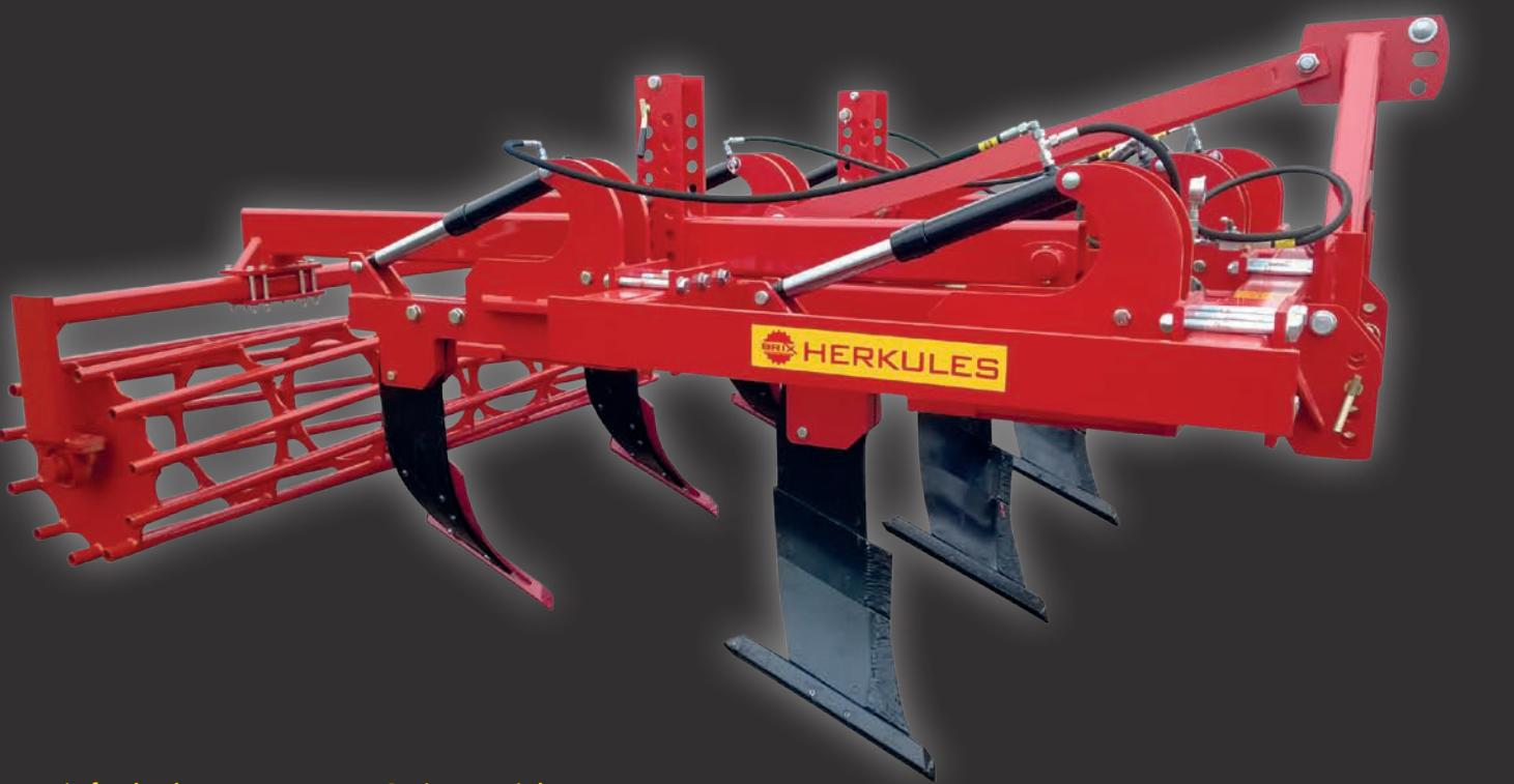
Der Tiefenlockerer HERKULES eignet sich besonders gut zur ganzflächigen Tiefenlockerung des Bodenuntergrundes unterhalb der Pflugsohle. Durch die Bogenstellung der Zinken wird der Boden angehoben, gut durchlüftet, aber nicht gedreht. Die auf zwei Balken versetzt angeordneten Bogenzinken lockern den Boden ganzflächig.
